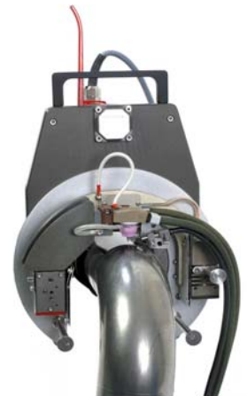
Сварочная головка MU IV с функциями АРНД (AVC) и колебания горелки (OSC)
