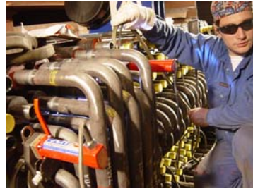
Сварочная головка MU IV: идеальна для применения в стесненных условиях.
