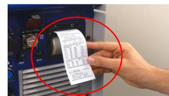
Встроенный принтер. Идеален для распечатки действительных значений сварки и сварочных программ.
