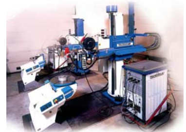
Сварочный источник PC 350 со столом вращения и автоматической консолью для высококачественной сварки изделий
