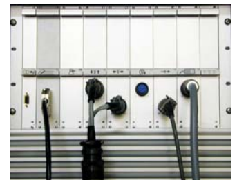
Встроенное CNC-управление процессом с индивидуальными блоками для каждой функции
