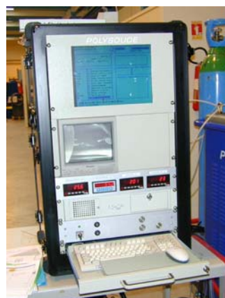
Версия для монтажных площадок "rack". Встроенная система регистрации, ПК для программирования в режиме on/off-line, а также видеонаблюдение
