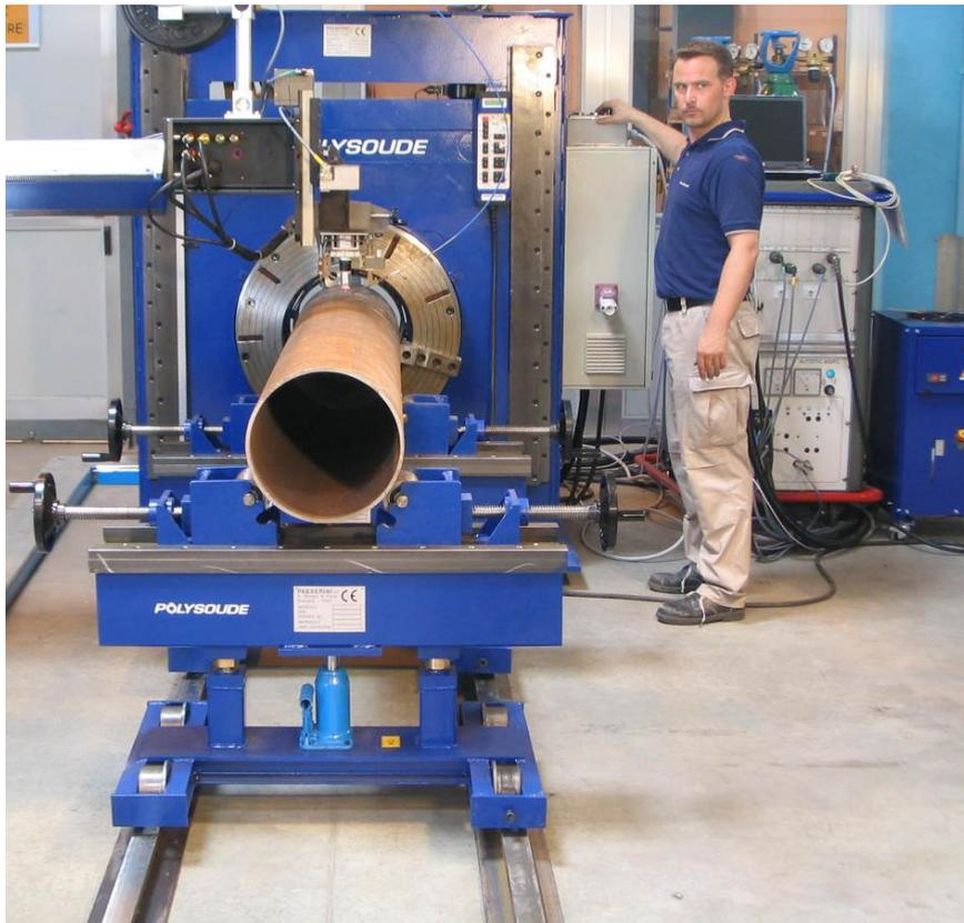
Сварка TIG/GTAW С НАГРЕТОЙ ПРОВОЛОКОЙ для заводской сборки труб
