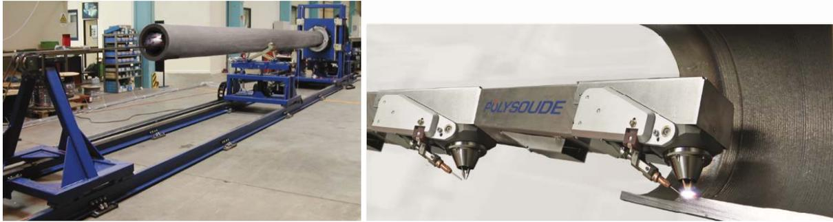
12-метровая горизонтальная установка плакирования **TWIN-TIG<sup>er</sup>** производства **POLYSOUDE SAS** (Франция).
