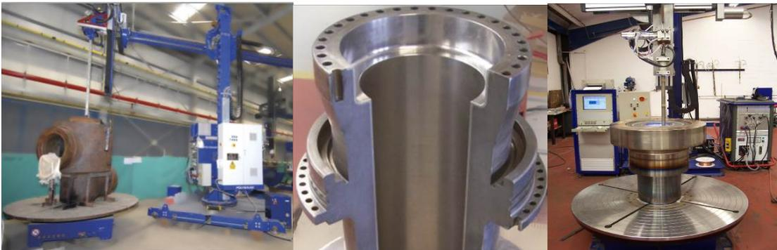
*Установки **POLYSOUDE SAS** для вертикального наплавления плакировки нагретым вольфрамовым электродом в среде инертного газа TIG/GTAW на любые типы коллекторов.*
