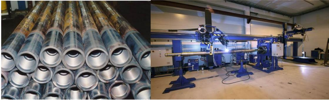
*Сварка TIG/GTAW с горячей проволокой, бурильные трубы из разнородного материала*
