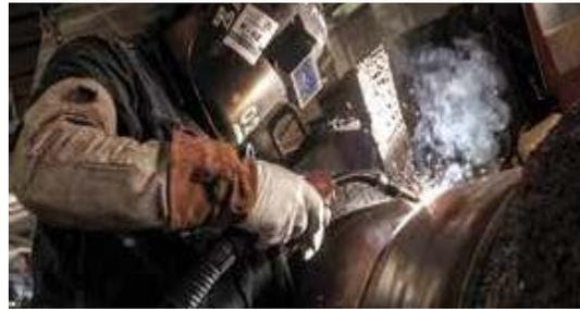
*FCAW: Сварка электродом с самоэкранированием и порошковым сердечником или GMAW: сварка со сплошной проволокой MIG/MAG*
