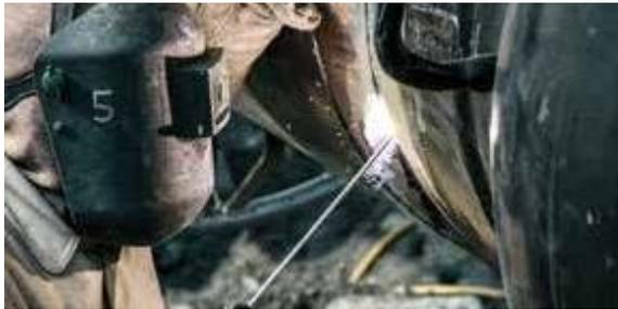
*SMAW: Сварка стержневым электродом с покрытием*
