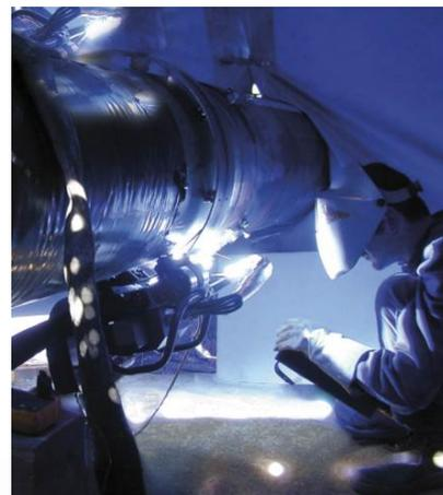
*Круговая сварка TIG/GTAW с горячей проволокой*
