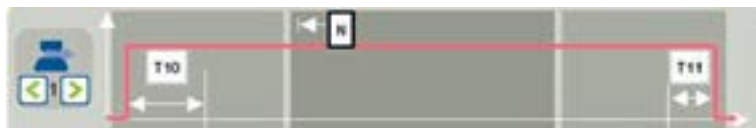
Мнемосхема управления газом на панели источника питания Polysoude серий P4 - P6
