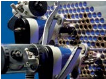
Головка для сварки соединений "труба - трубная доска" TS 8/75
