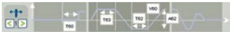
Мнемосхема управления поперечными колебаниями на панели источника питания Polysoude серий P4 - P6
