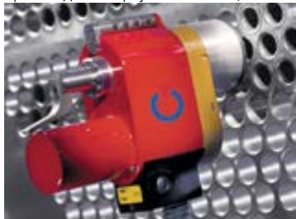
Пример применения оборудования с 3-мя осями: сварочная головка TS 34
