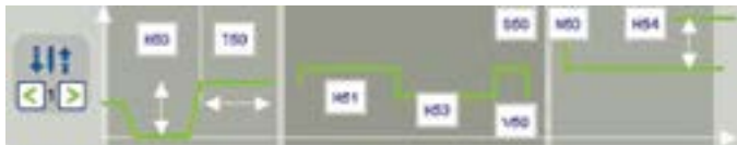
Мнемосхема управления АРНД на панели источника питания Polysoude серий P4 - P6
