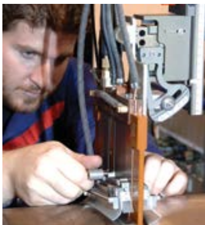
Горелка для ВИГ-сварки в щелевую разделку с подогретой присадочной проволокой
