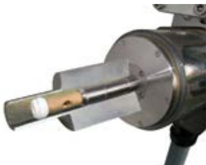
Пример сварки утепленных труб в трубную доску
