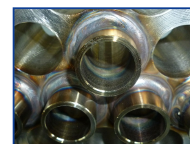
Высокое качество сварных швов сохраняется даже при сварке в стесненных условиях выступающих труб
