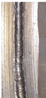
Рис. 32 - Участок шва "на подъем" (слева) и "на спуск" (справа)
