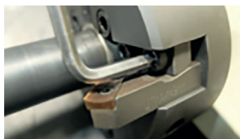
Рис. 16 - Жесткое крепление резцов обеспечивается применением соответствующих сухарей
