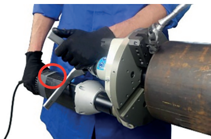
Рис. 17- Красным кругом отмечен регулятор настройки скорости установки US40 с электрическим приводом
