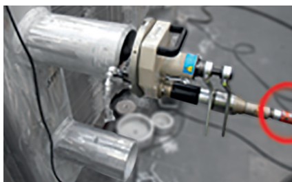
Рис. 18- Красным кругом отмечен регулировочный вентиль установки US40 с пневматическим приводом
