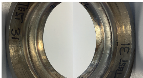
Рис. 21 - Слева – сварной шов в положении на подъем, справа – на спуск
