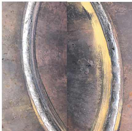
Рис. 25- Сварной шов в положении на подъем – слева и на спуск – справа
