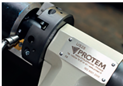
Рис. 13 - Установка для мех. обработки кромок US25CH с держателем резца 30° и 90°
