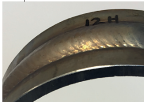
Рис. 28- Вид облицовочного шва при ВИГ-сварке с подогретой проволокой толстостенных соединений "труба-отвод"
