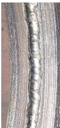
Рис. 32 - Участок шва "на подъем" (слева) и "на спуск" (справа)
