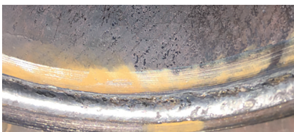
Рис. 24- Сварной шов в нижнем положении – вверху и в потолочном положении – внизу
