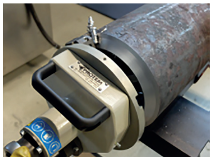
Рис. 8 - Мобильная установка для механической подготовки кромок отрезанных в размер труб
