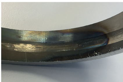
Рис. 34 - Дефекты сварного соединения, выполненного из коррозионно-стойкой стали с ограниченной свариваемостью. Усугублено V-образной разделкой
