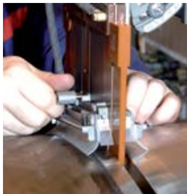
Рис.8: Модуль горелки NG - толщины свариваемых заготовок до 250 мм
