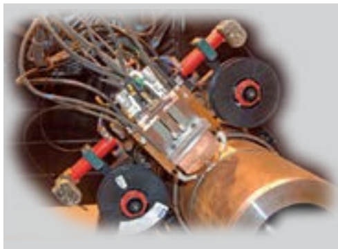
Рис. 28: Головка с двумя катушками проволоки, адаптированная для сварки полупроходов
