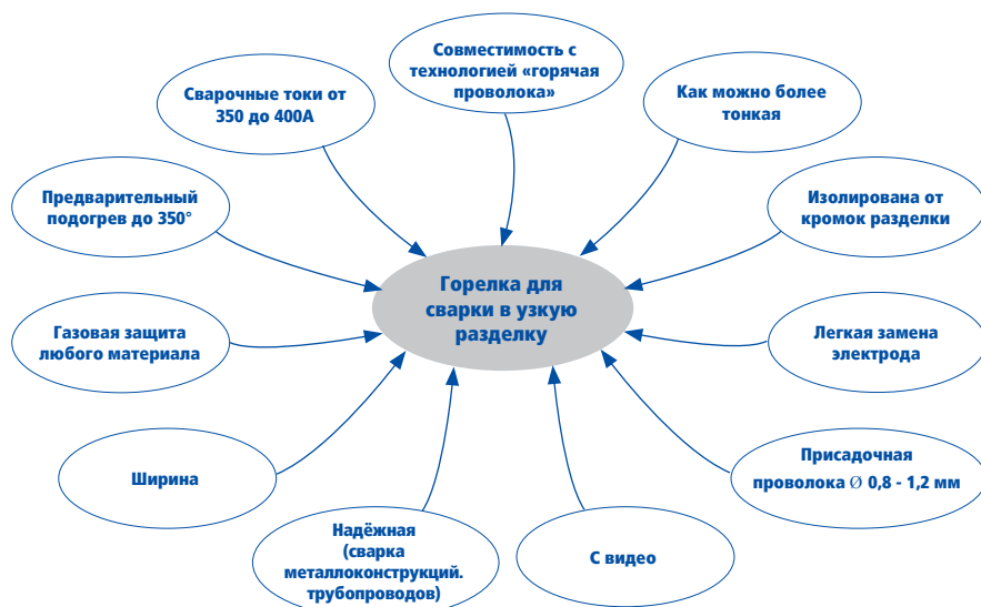
Рис. 1: многочисленные требования к конструкции горелки
