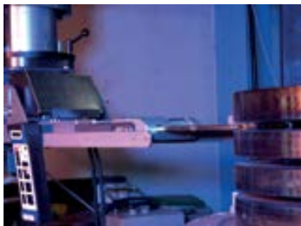
Рис. 37: Сварочная головка для сварки роторов турбин
