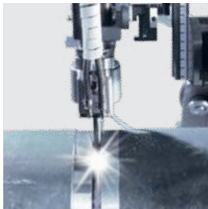
Рис. 7: Горелка NG-V2 или V3 для толщин от 0 до 100 мм
