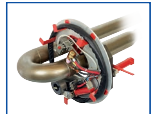
Сварочная головка, подходящая для сварки в стесненных условиях
