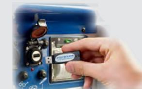
Запись/передача и архивирование сварочных программ и действительных значений используя USB-накопитель
