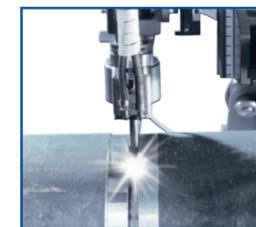
Модуль горелки „V2“ для толщины стенки до 75 мм
