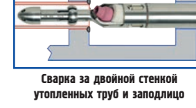
Сварка за двойной стенкой труб с малым вылетом
