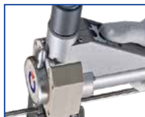
Эргономичность: пульт управления, интегрированный в сварочную головку UHP 625
