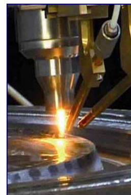
ВИГ- сварка с холодной, подогретой проволокой
