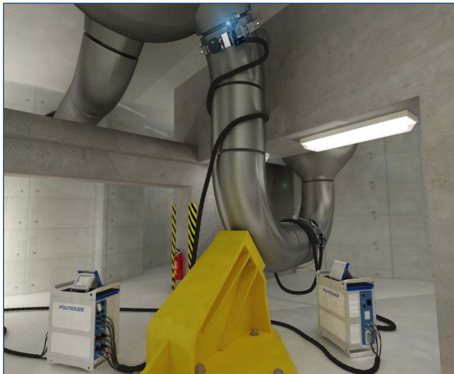
Сварочный ВИГ-трактор POLYCAR 60-2 PLC
