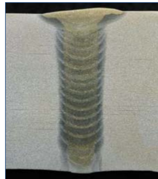
Микрошлиф соединения, сваренного способом ВИГ-сварки в узкощелевую разделку с подогретой проволокой
