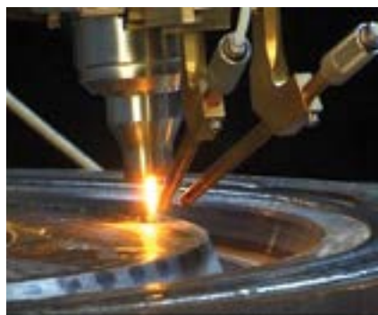
Рис. 18: Пример горелки для ВИГ-сварки с механизированным газовым соплом и подачей двух горячих проволок
