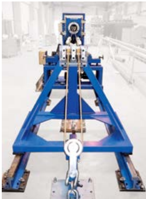
Рис. 52: Установка для наплавки внутренней поверхности трубы длиной до 12 м. Катушки с проволокой монтируются на каретку, которая осуществляет подачу сварочного копы, установленного на натянутые стальные тросы.
