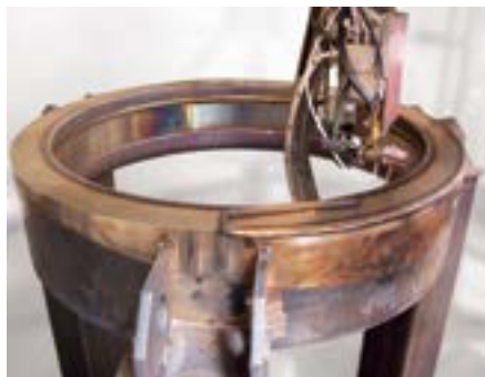
Рис. 44: Копье с приводом для изменения угла для нанесения слоя из стали 309L-308L на внутреннюю поверхность переходника парогенератора.
