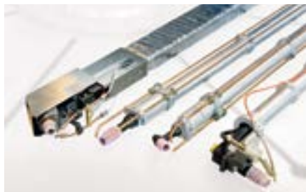
Рис. 43: Сварочные копы для нанесения покрытий на внутренние поверхности отверстий. Существуют исполнения с подачей одной и двух присадочных проволок. Углы горелок подобраны в соответствии с задачей (наплавка стенки, дна, переходов между стенкой и дном). Копья имеют водяное охлаждение.
