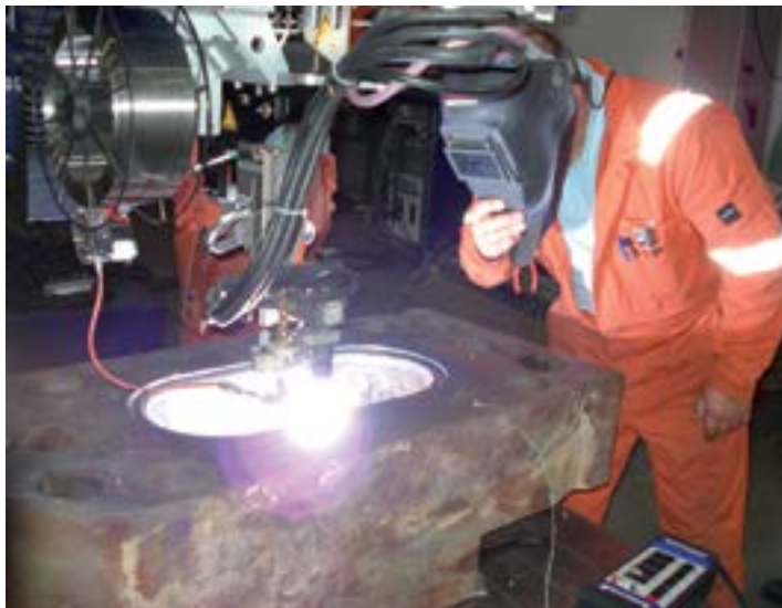
Рис. 1: Наплавка коррозионностойкого материала на клапан
