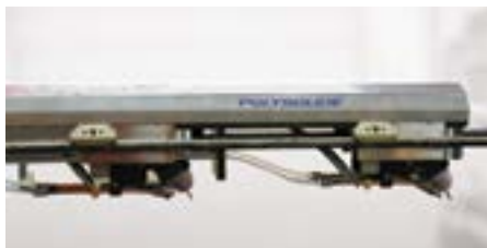
Рис. 53: Передняя часть сварочного копы скользит по двум горизонтально натянутым стальным тросам. Покрытие состоит из двух слоев, наносимых за один проход двумя расположенными друг за другом сварочными горелками с двойной подачей проволоки. Покрытие конца труба должно производиться за одну отдельную рабочую операцию (обусловлено смещением между горелками).
