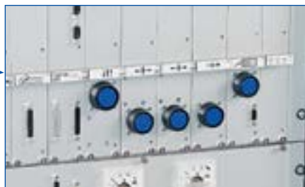
Рис. 30: Мультифункциональный источник тока с модульной конструкцией системы управления. Благодаря возможности расширения парка оборудования, можно производить наплавку любой сложности.
