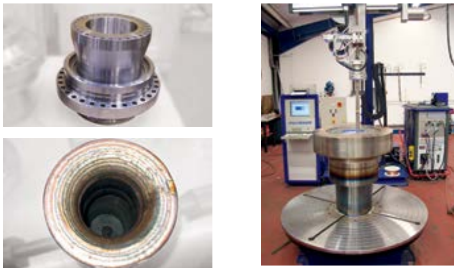
Рис. 4 : Стационарная сварочная установка в производственном цехе. Наплавка никелевого сплава на внутренние поверхности деталей: стенок, дна, переходов.
