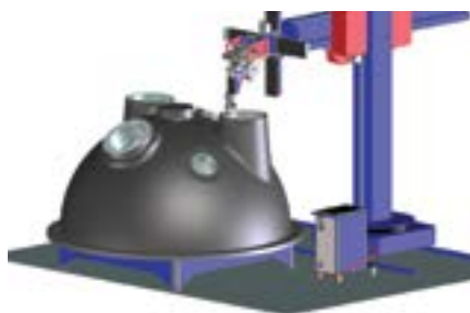
Рис. 5: Наплавка переходного слоя на торец трубы для последующей приварки детали из разнородного материала
