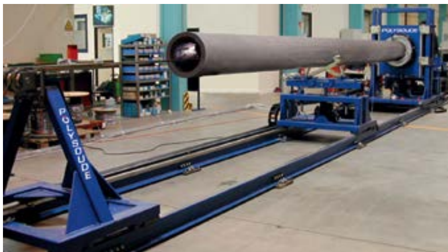
Рис. 55: Длинная труба, подготовленная для наплавки внутренней поверхности. Труба, опирающаяся на роликовую опору, зажимается в патроне со сквозным отверстием и приводится во вращение. Сварочное копы поддерживается двумя стальными тросами, натяжение которых создается за счет устройства на переднем плане.
