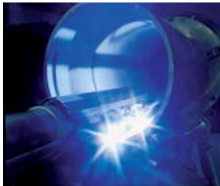
Рис. 51: Наплавка внутренней поверхности трубы с подачей двух горячих проволок (внутренний суппорт АРНД не виден). Как правило, этот процесс выполняется непрерывно и требует охлаждения трубы, чтобы выдерживать межпроходную температуру
