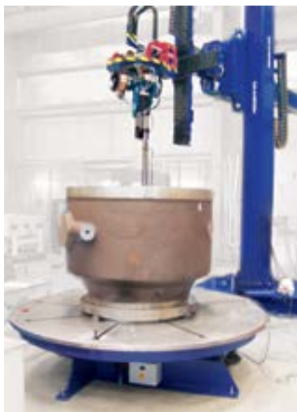
Рис. 45: Наплавка внутреннюю поверхность цилиндрической детали. Вертикальное перемещение производится при помощи специального суппорта большой грузоподъемности.
