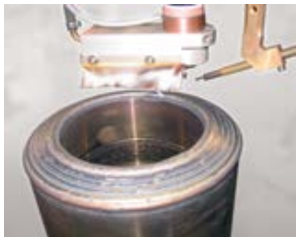
Рис. 5: Наплавка переходного слоя на торец трубы для последующей приварки детали из разнородного материала
