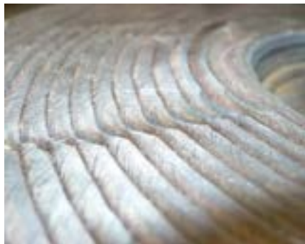
Рис. 33: ВИГ-Наплавка с подачей горячей проволоки техникой «Step over». Скорость сварки автоматически корректируется при изменении диаметра.
