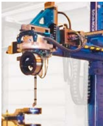
Рис. 47: Копье с углом установки 45^\circ , расположенное на коллекторной головке. Диаметр наплавки задается горизонтальным суппортом
