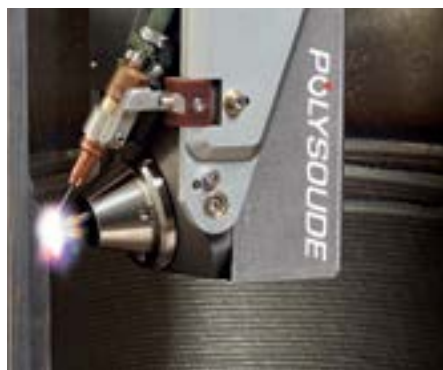
Рис. 27: Наплавка на вертикальную поверхность неподвижной детали с применением технологии TIG er
