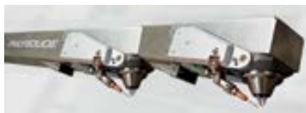
Рис. 54: также и при наплавке по технологии TIG ® со сдвоенной ВИГ-дугой два слоя могут быть нанесены за один проход. Обе горелки оборудованы одним подводом проволоки и смонтированы на одной сварочной насадке.
