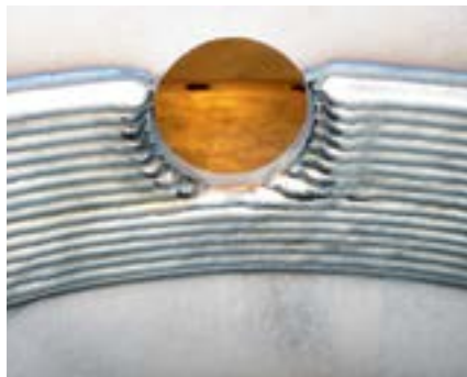
Рис. 34: Наплавленные валики на внутренней поверхности цилиндрической детали. Наплавка автоматически прерывалась (перед отверстием) и возобновлялась (после отверстия).
