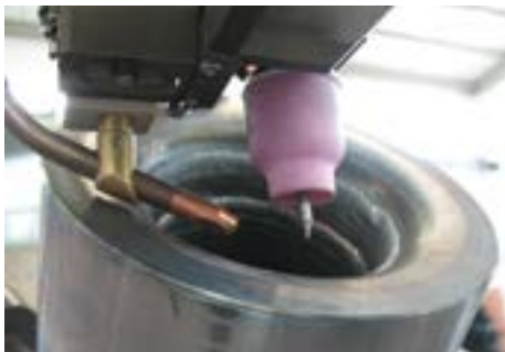
Рис. 12: Линза в сварочной горелке обеспечивает ламинарный поток защитного газа
