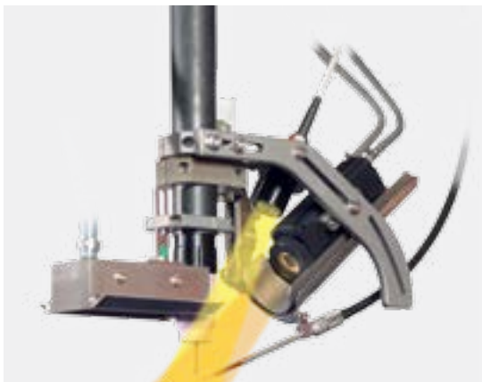
Рис. 31 : Камера видеонаблюдения на горелке WP27
